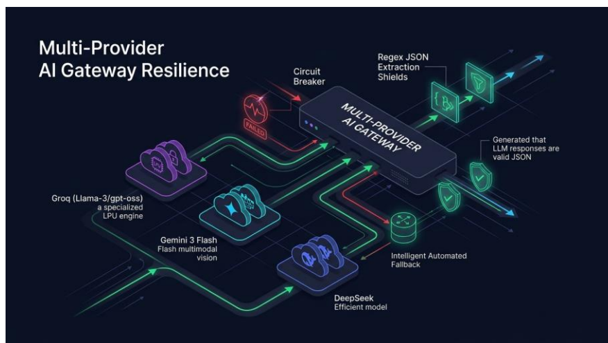
Figura 8.1: Resiliência Multi-Provedor no AI Gateway — Roteamento primário de ultra-alta velocidade na Groq LPU, contingência automática para modelos de contingência (DeepSeek) e sanitização defensiva de JSON na borda
